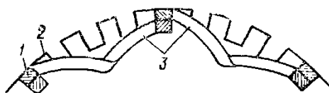
Рис. 2.2. Двухслойное расположение секций обмотки якоря
