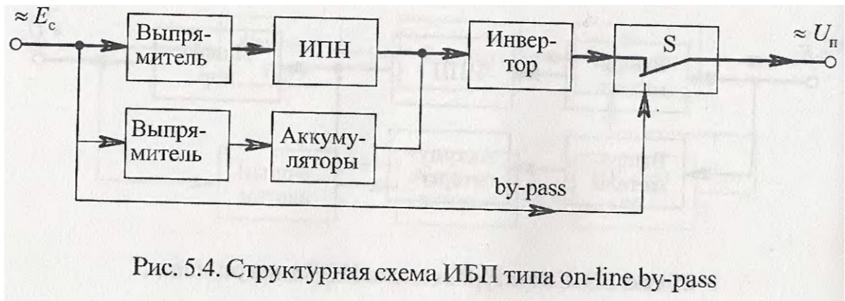
Рис. 4. Структурна схема ДБЖ типу on-line by-pass
