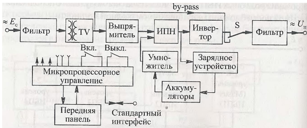
Рис. 6. Перший варіант блок-схеми ДБЖ типу on-line by-pass
