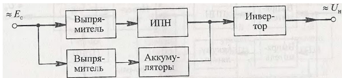
Рис. 3. Структурна схема ДБЖ типу on-line
