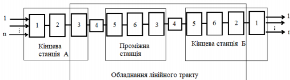
Рисунок 2.1 - Узагальнена структура схема ВОСП (для одного напрямку передачі)
