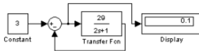
Рис. 9.6. Структурна схема для перевірки результатів розрахунку
