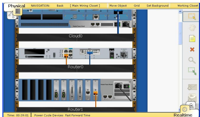
Рис.11 - Пристрої, що розміщені в комутаційній шафі.
