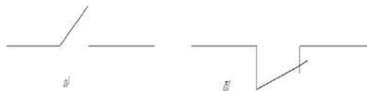
Мал.3 Зображення контактів (а) - нормально закритий, (б) - нормально відкритий
