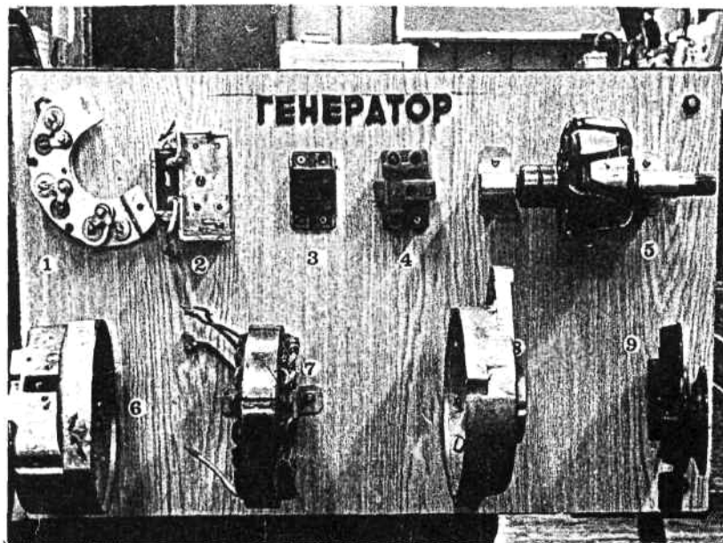
Рис.1 Стенд автомобільного генератора у розібраному виді.
